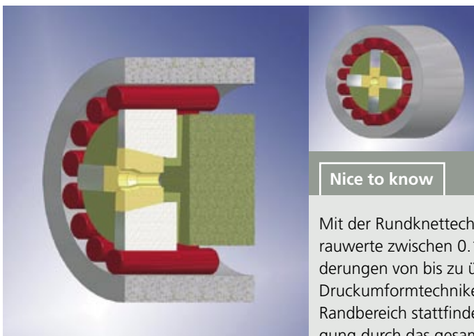
Das Knetwerk mit umlaufendem Rollenpaket.
