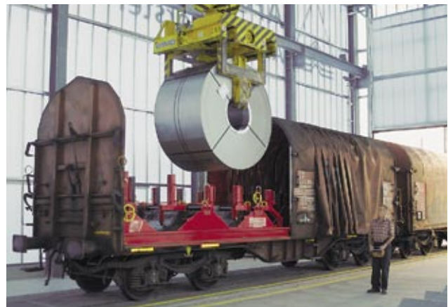
Mit einer Seilspinnanlage wird der Zug in die neue Coil-Umladestation der AFG Arbonia-Forster-Holding AG gezogen. Die Umladestation befindet sich in Romanshorn, in der Nähe der Schiffsanlegestelle der Fähre Romanshorn–Friedrichshafen.
