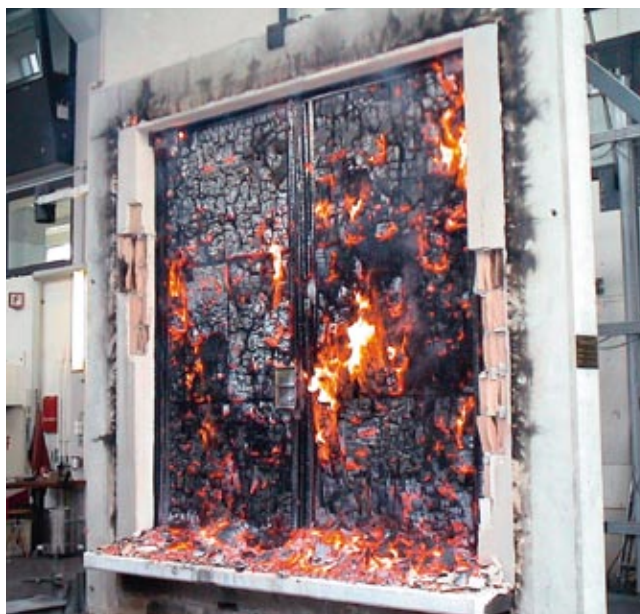
Brandschutzprüfung des neuen Türelements KS68-G OZR.
