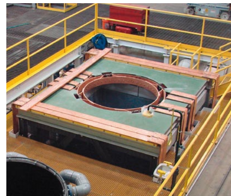
Die neue Anlage kann Bauteile bis 2 000 mm Durchmesser und bis 8 000 mm Länge verchromen.
