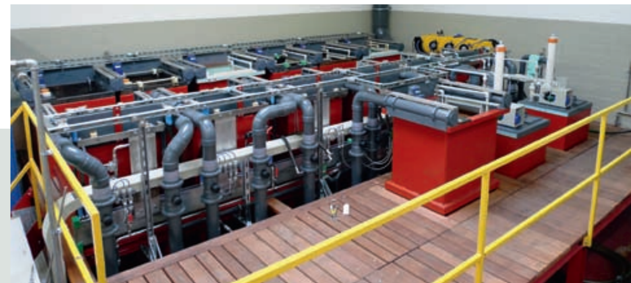
Gezielte Forschung möglich – mit einer modernisierten Versuchsgalvanik mit aktuell 13 Bädern.
