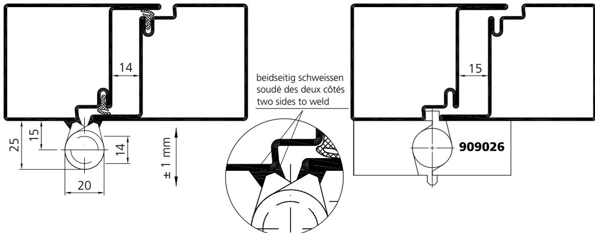
Für ein spannungsfreies Schliessen ist die Bandachse zentrisch über die Schattenfuge zu positionieren.
