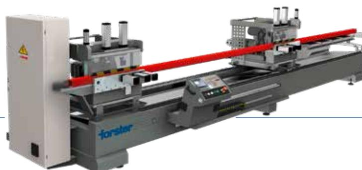
forster steel tec, das Stabbearbeitungszentrum mit vier CNC-gesteuerten Achsen erfüllt sämtliche Anforderungen des Fenster- und Türenbaus. Konzipiert für Stahl, Edelstahl und Aluminium bis 3 mm.
