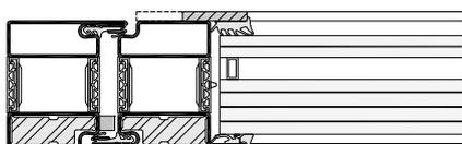
Acier plat intercalé  $\geq 5$  mm, (soudé aux extrémités du profilé)
